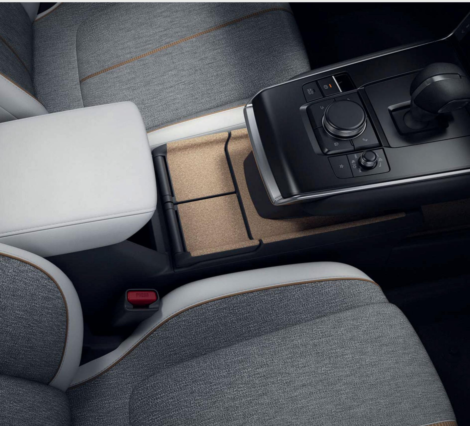
Korken som används i mittkonsolen och på insidan av dörrhandtagen är både slitstark och snygg att se på. Korkmaterialet bidrar till en ombonad känsla och förmedlar precis som många andra naturliga material en hög kvalitet, och har en låg inverkan på miljön.
