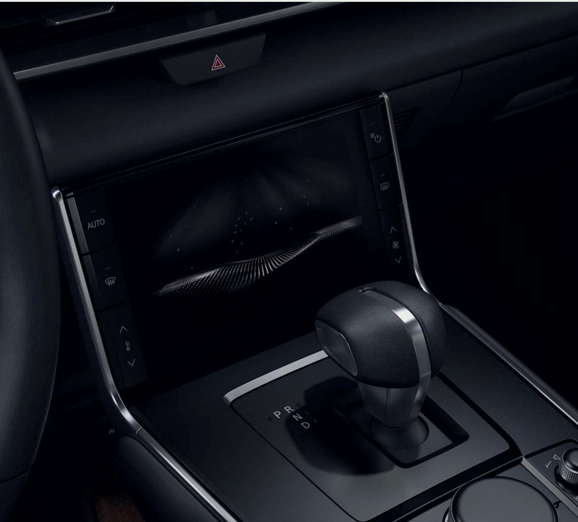
Klimatanläggningen styrs via en snygg pekskärm, som även har fysiska knappar på sidorna om displayen om man föredrar det alternativet.
